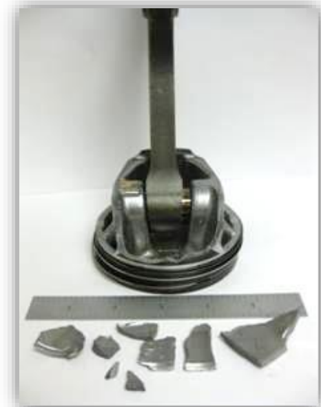
Rotura de la falda del Pistón , solo en casos severos de LSPI
